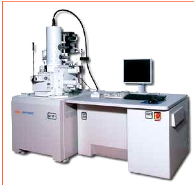
10 pav. Mikroskopas JEOL 7600F. Erdvinė skyra -1 nm, analitinė skyra -3 nm;
